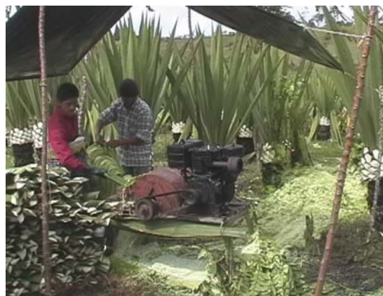
Foto No. 4. Maquina convencional de desfibrado
